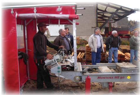
Le premier matériel choisi en 2010 fut une scie mobile de marque allemande : une SERRA MONTANA ME90. Ces caractéristiques lui permettaient de scier des troncs de 80 cm de diamètre et jusqu'à 9.50 de long. L'investissement était modéré et a permis à Emmanuel de commencer à apprendre le métier. Nous avons lors de chaque
